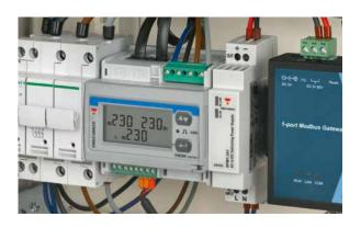
Mit nur einem Klick sind die Stromwandler mit den Energiezählern verbunden – Nullfehlerquote! Das Übersetzungsverhältnis wird von der EM/ET-Serie automatisch aus dem Stromwandler ausgelesen und gesetzt.
